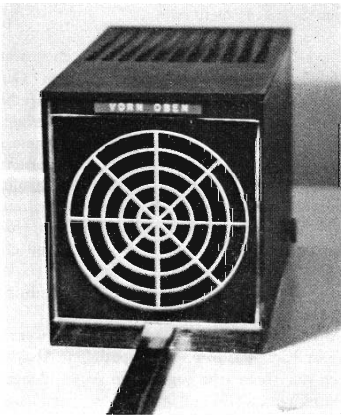
Abb. 2 Das Testzeichen befindet sich in einem Lampengehäuse und wird mit Hilfe einer Fresnel-Linse lichtstark beleuchtet. Es lassen sich verschiedene Testzeichen einschieben: Speichenrad, Optotypen, beleuchteter Punkt.
