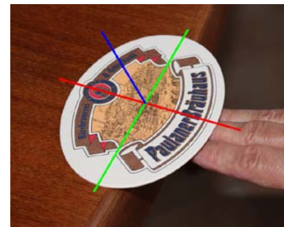
Abb.5: Hauptträgheitsachsen eines elliptischen Bierdeckels. Die Achse des kleinsten Trägheitsmoments ist grün markiert (von links unten nach rechts oben).
