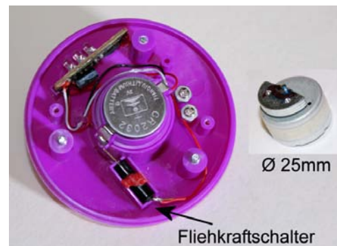
Abb.5: Das Innere des Non-stop-tops 1. Der Motor mit einer Unwucht (rechts im Bild) befindet sich unterhalb der Knopfzellen.
