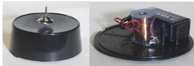
Abb.1a: Ein Dauerkreisel mit dem Namen TopSecret; links Basis mit Kreisel, rechts das Innere der Basis. Deutlich zu erkennen eine Spule und 9V-Batterie.
