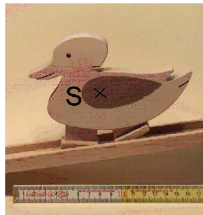
Abb.1: Eine Wackelente bewegt sich schaukelnd eine schiefe Ebene nach unten. Das Kreuz markiert den Schwerpunkt und hier zugleich Drehpunkt des hinteren Fußes.
