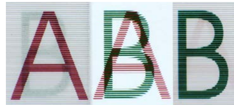
Abb. 4: In der Mitte sind die Buchstaben A und B mit dem Programm 3D-Easy als Wackelbild für eine 30lpi-Linsenrasterfolie ausgedruckt. Links bzw. rechts ist die Linsenrasterfolie darüber gelegt. Schwach erkennt man noch den jeweils anderen Buchstaben. Betrachtungsabstand 50cm; senkrecht.
