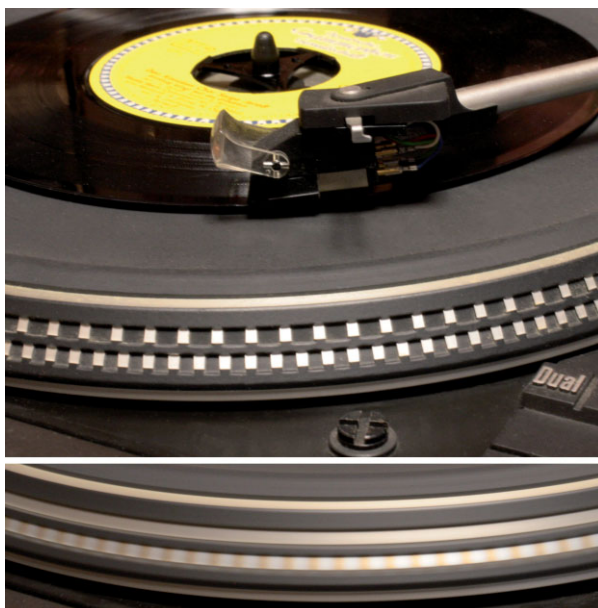
Abb. 1 Drehteller eines Plattenspielers mit Markierungen. Darunter mit 33 U/min und Glühlampenbeleuchtung.
