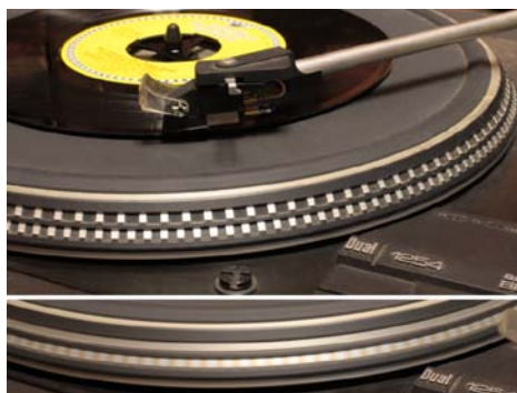
Abb.1: Drehteller eines Plattenspielers mit Markierungen. Darunter mit 33U/min und Glühlampenbeleuchtung..
