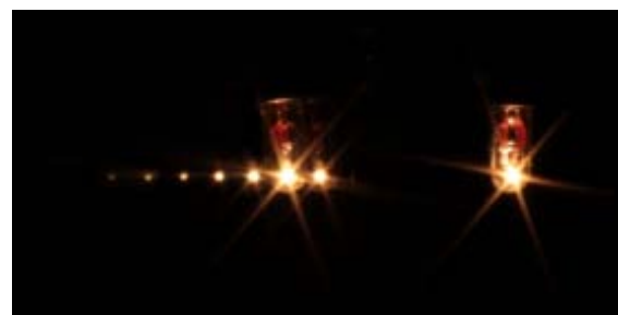
Abb.4: Die Glühlampe einer Taschenlampe nahe an einen Spiegel (~1cm) positioniert und unter schrägem Blickwinkel betrachtet.
