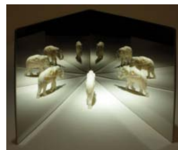
Abb.6: Mehrfachreflexionen zwischen zwei ebenen, nicht parallelen Edeltstahlsiegeln (Winkel 40^\circ ).
