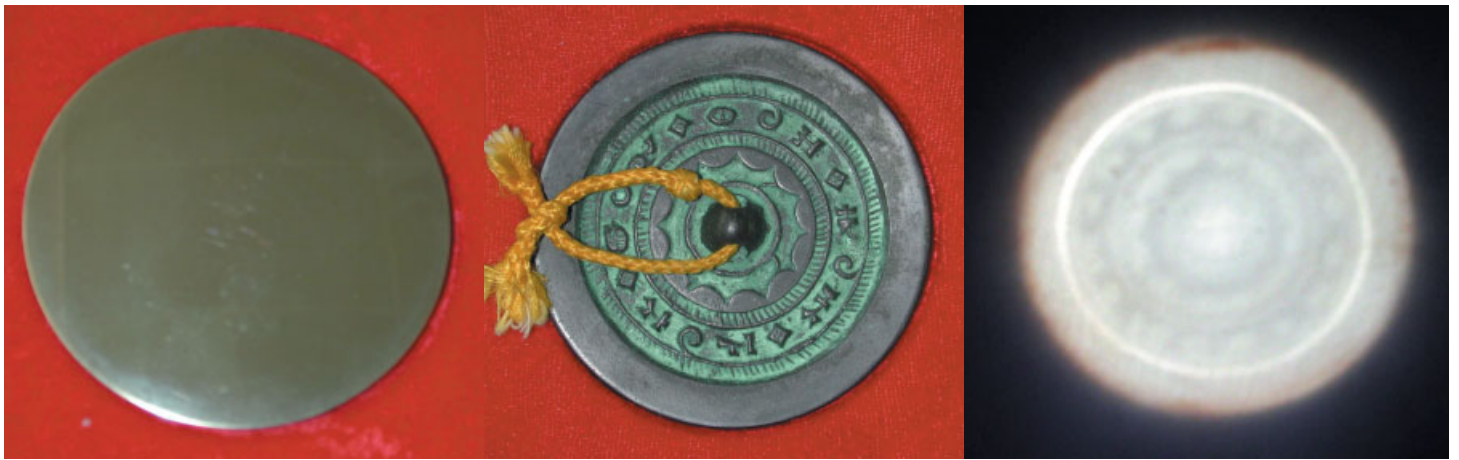
Abb. 2 Ein Zauberspiegel in seiner Schatulle, links die Vorderseite, Mitte die Rückseite und rechts das Reflexbild.
