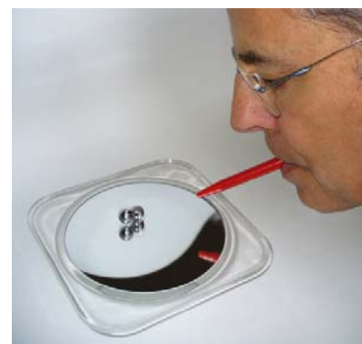
Abb. 6: Magnetkugeln lassen sich mit einem Strohhalm bis fast 10.000 U/min hochdrehen.
