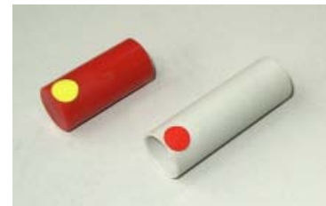
Abb.1: Zylinder als Kreisel. Der rote Zylinder ist massiv, der graue hohl.
