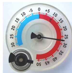
Abb.1: Thermometer mit Bimetallspirale. Die Spirale ist links unten im Bild vergrößert dargestellt.
