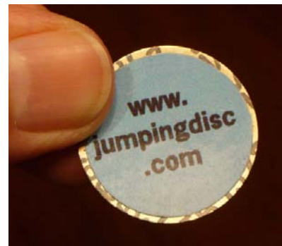
Abb.3: Eine Klickscheibe (jumping disc; \varnothing = 2,5\text{cm} ; m = 1,235\text{ g} ) zwischen zwei Fingern.
