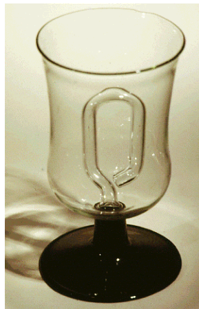
Abb. 2: Besser wäre es, wenn der "Mechanismus" in der Wandung des Gefäßes versteckt ist, wie hier durchsichtig an einem Prototyp demonstriert.
