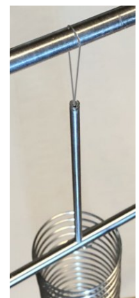
Abb.3: Aufhängung des Federpendels.
