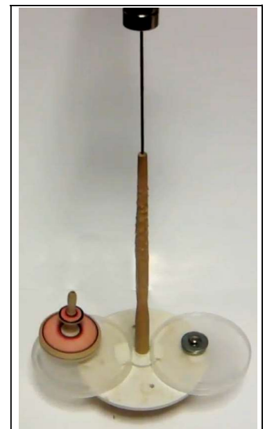
Abb. 4: An einem Magneten hängende Vorrichtung, um zwei Kreisel rotierend auf konkaven Scheiben aufzusetzen. Im Bild ist ein Kreisel durch ein äquivalentes Gewicht ersetzt.
