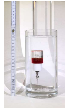
Abb.5: Kalibrierung des Systems mit zusätzlichem Gefäß. Temperatur \sim 32^\circ\text{C} .
