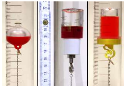
Abb.4: Eine Kugel aus einem ausgelaufenen Galilei-Thermometer (links); ein Kunststofffläschchen (Shampoo) mit magnetischer Halterung (Mitte); ein Ohropax-Döschen (rechts).
