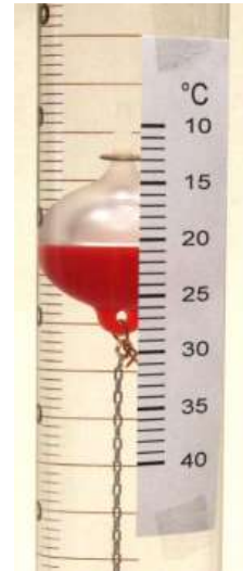
Abb. 7: Eigenkonstruktion des Kettenthermometers mit kalibrierter Celsius-Skala.
