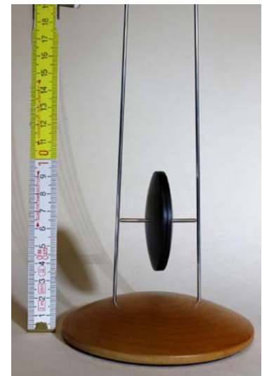
Abb.3: Das Sisyphos-Rad mit magnetischer Achse.
