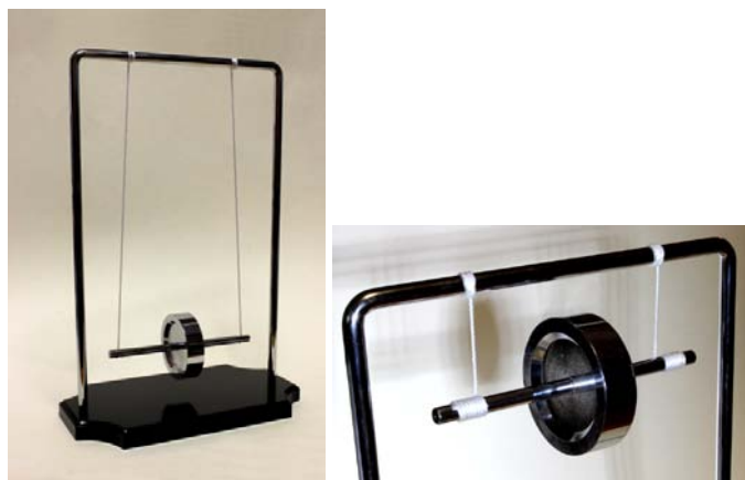
Abb.1: Maxwellsches Fallrad als Designobjekt; Gesamthöhe 32cm. Rechts befindet sich das Rad in aufgewickeltem Zustand in fast maximaler Höhe.
