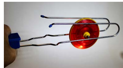
Abb.5: Ein sogenanntes Zauberrad ist eine spielerische Variation des Maxwell Rads. Hier kann man die Bewegungsumkehr aufgrund der Verbreiterung des Stangenabstands sehr gut beobachten.
