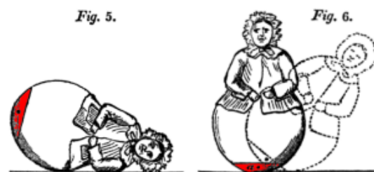
Abb.1: Klassische Stehauffigur nach Faraday [1]. Rot markiert das schwere Gewicht.
